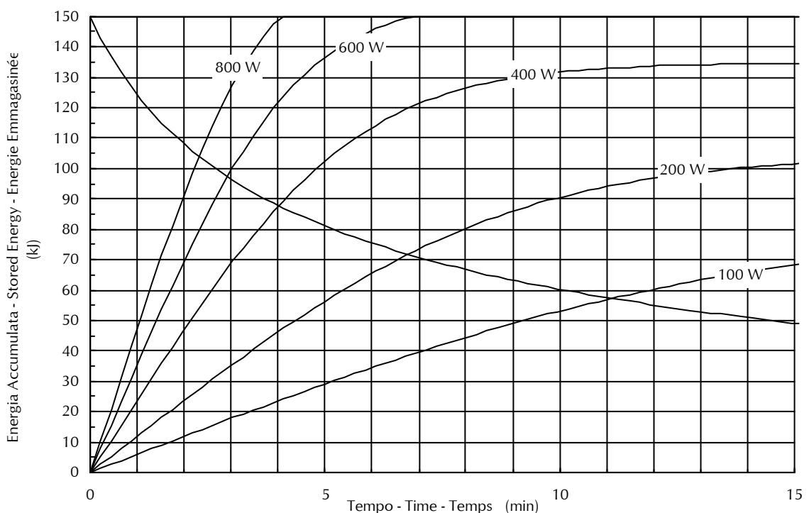
**CURVE DI CARICO SINGOLO - SINGLE LOAD RATING - ABAQUE DE CHARGE UNIQUE**
