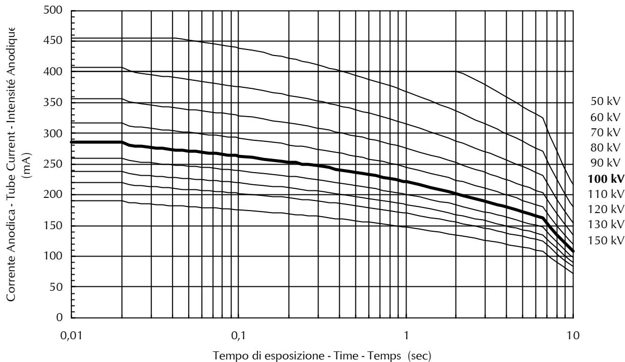
**CURVE DI CARICO SINGOLO - SINGLE LOAD RATING - ABAQUE DE CHARGE UNIQUE**
